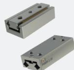
Der Miniaturschlitten **MSR** verfügt über integrierte Kreuzrollenführungen und eine Käfigzwangssteuerung. Es ist der kleinste verfügbare Schlitten in der Branche. Es gibt 7 Größen, alle aus Edelstahl gefertigt. Verfahrweg: 5 - 112 mm.
