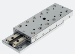
Die Lineartische vom Typ **RTNG** bieten zusätzliche Vorteile bei Anwendungen in schmutzigen Umgebungen. Der äußerst enge Dichtspalt zwischen Ober- und Unterteil verhindert das Eindringen von Staub oder Spänen. Sie sind in einer Vielzahl von Baugrößen und Längen lieferbar, für Verfahrwege von 10 bis 950 mm und eine Tragfähigkeit von bis zu 35.100 N.
