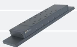
Die Lineartische vom Typ **RTS** mit niedriger Bauhöhe sind entwickelt um weniger Gewicht und weniger Raum zu beanspruchen. Sie gewährleisten eine hohe Ablaufgenauigkeit bis in den Mikrometerbereich. Diese kreuzrollengelagerten Lineartische bieten Verfahrwege von 12 - 130 mm und eine max. Traglast von 3.672 N.
